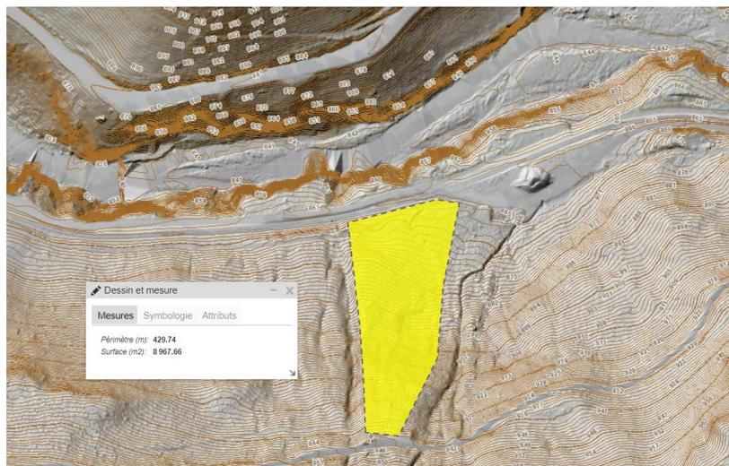
Figure 4 : Surface de ruissellement prise en compte pour la surface de talus amont des voies.
